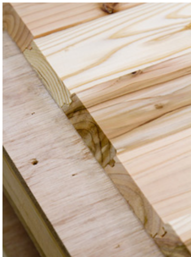
バラ板本実矧型枠（現在のもの）
